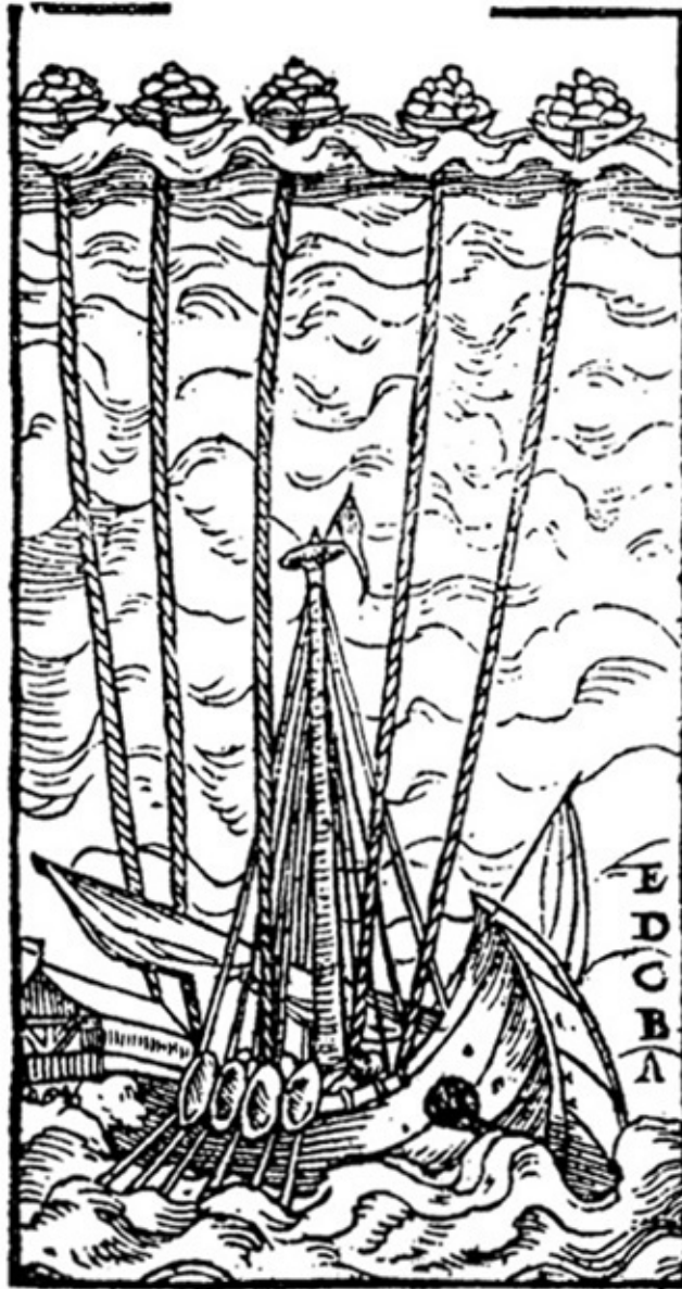
Sistema para rescatar barcos hundidos mediante barcas y cuerdas que se llenan y vacían de piedras (De subtilitate, I).
