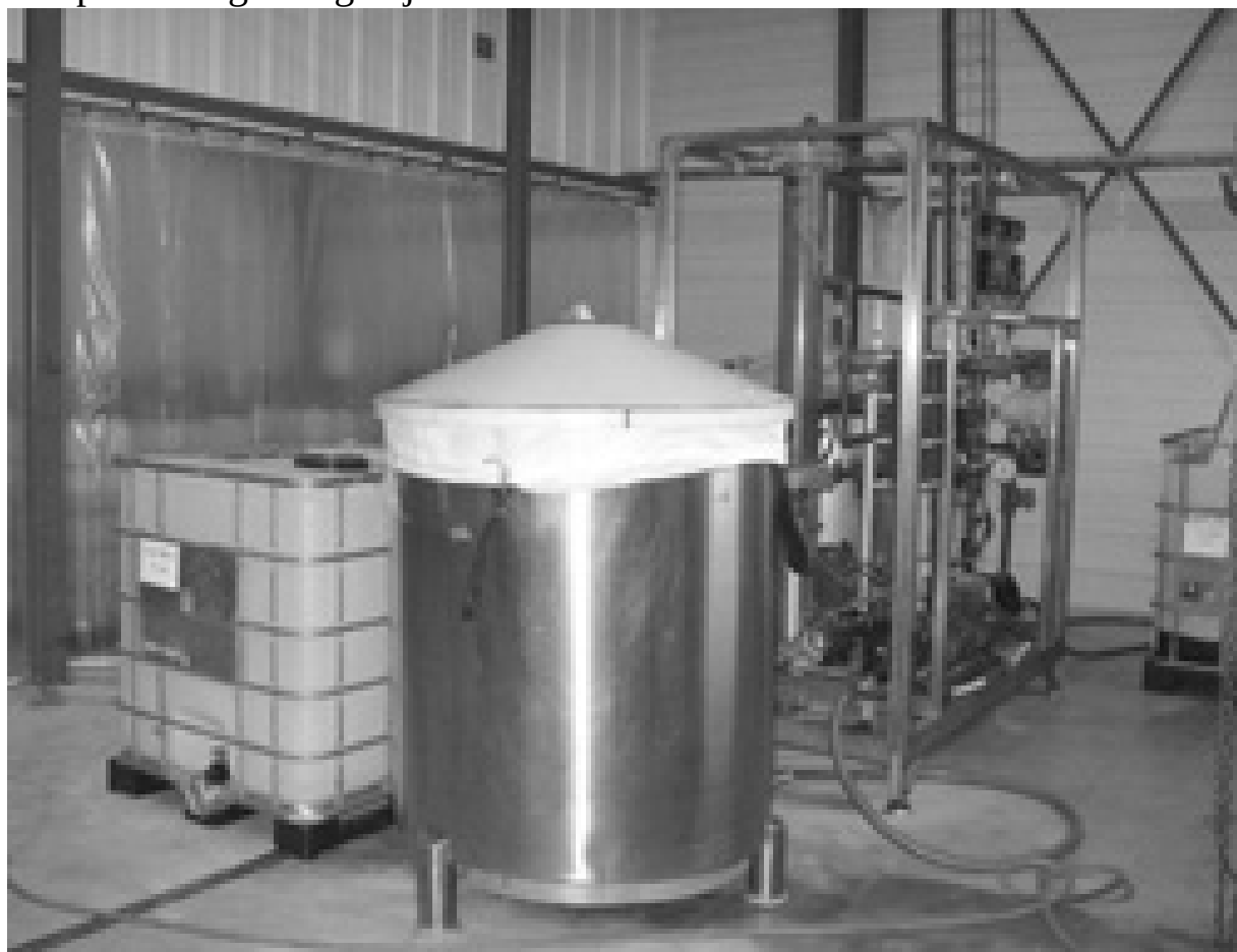
Cuve de multi-extraction par lixiviation avec son système de filtration (photographie prise lors de la visite des sites de PiLeJe Industrie).
