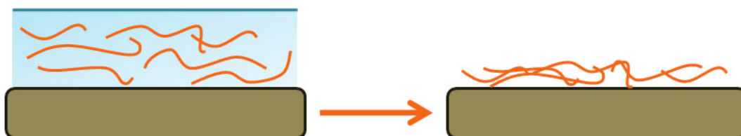
FIGURE 8.2 – Formation d'un film par évaporation du solvant
