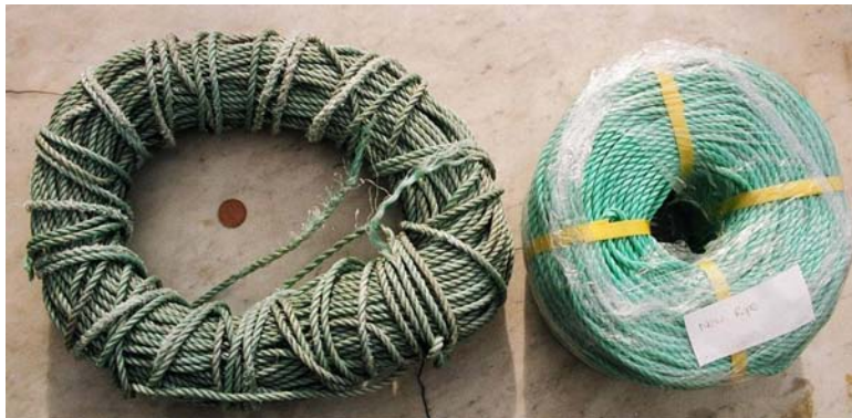
FIGURE 9.1 – Effet des UV sur une corde en fibres de polypropylène
