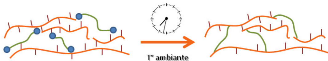
FIGURE 8.11 – Principe du séchage par mélange de deux composants
