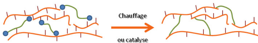
FIGURE 8.12 – Principe du séchage par cuisson ou catalyse
