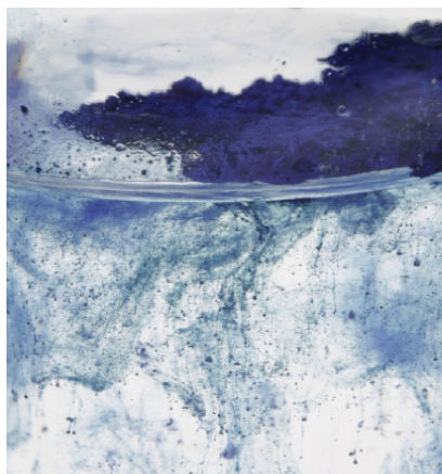
FIGURE 3.3 – Mouillage de pigments de « bleu phtalo » par l'eau
