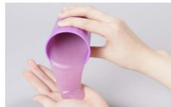
FIGURE 5.1 – Solide ou liquide ? Pour de nombreux matériaux, tout dépend de la contrainte, de son intensité, de sa durée. Chaque matériau est caractérisé par un comportement, que les mesures rhéologiques doivent mettre en évidence.
