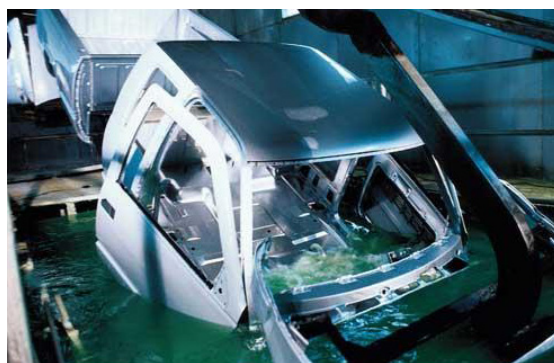
FIGURE 7.8 – Passage d'un pièce dans un bain phosphatant
