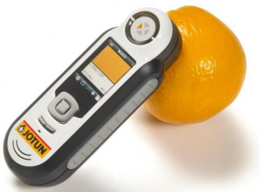
FIGURE 11.11 – Utilisation d'un colorimètre tristimulaire dans l'alimentaire
