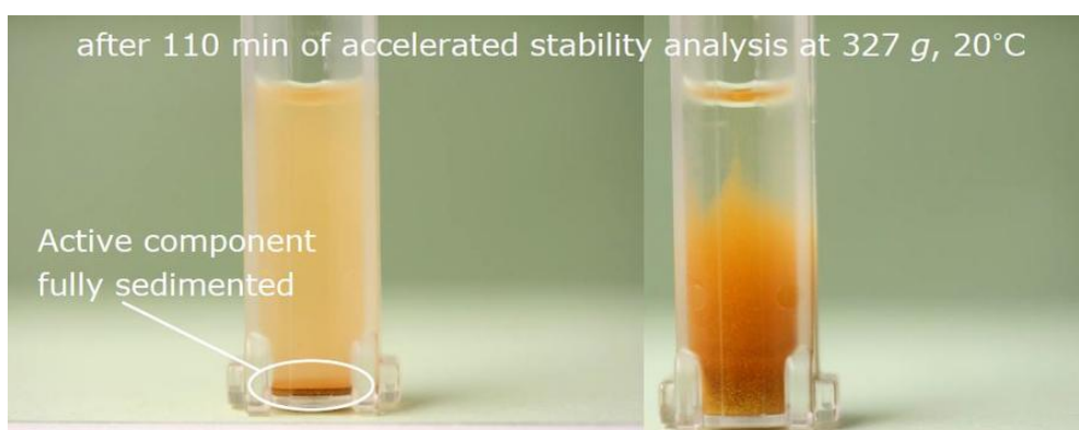
FIGURE 6.7 – Stabilisation d'un vernis à ongles avec un épaississant minéral. À gauche, le vernis non stabilisé sédimente. À droite, le vernis stabilisé à l'aide de silice pyrogénée.
