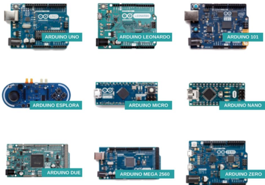
Figura 2 - Algumas versões da placa Arduino
