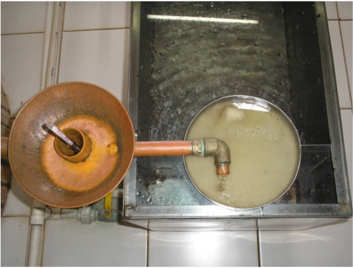
Figura 37 – Alambiques Separação: cabeça, coração e calda.
