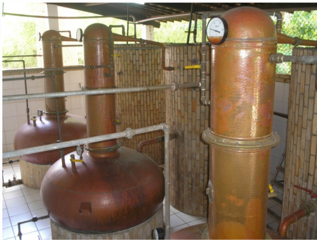
Figura 36 – Alambiques de cobre
