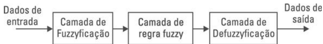
FIGURA 5.1 Diagrama de um sistema Neuro-Fuzzy. Fonte: Oliveira et al., 2011 .
