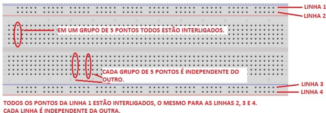
Figura 48 - Funcionamento do breadboard
