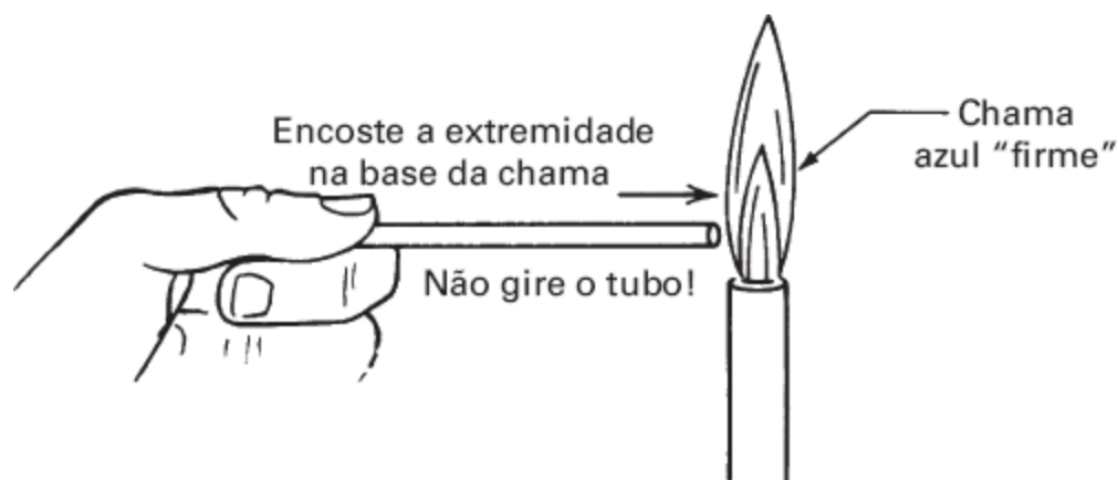
FIGURA 12.2 Fechando um tubo de p.fus com uma chama.
