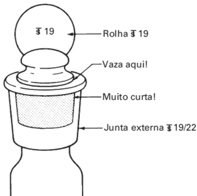
FIGURA 4.2 Uma junta não padronizada T 19 em uma junta padronizada T 19/22.
