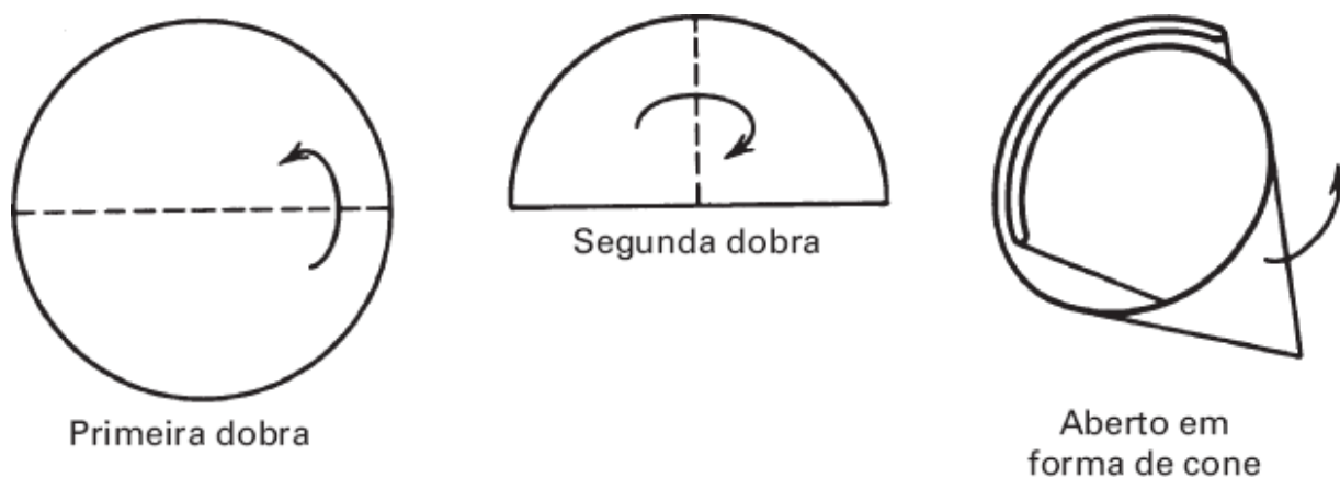
FIGURA 13.1 Dobrando o filtro de papel para filtração por gravidade.
