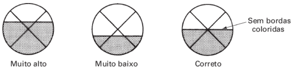
FIGURA 29.3 Sua amostra através da lente do refratômetro.
