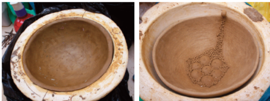
Figuras 5 e 6 - Placas de argila assentadas nos moldes de gesso (a figura superior ainda com argila úmida e a figura de baixo já em ponto de couro). Atelier de Cerâmica do Instituto de Artes da Unesp, 2007 e 2008. Foto: Flávia Leme.
