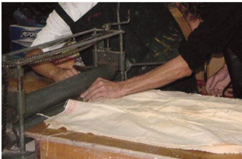
Figura 4 - Prensa para fazer placas de argila. Atelier de Cerâmica do Instituto de Artes da Unesp, 2003. Foto: Flávia Leme.
