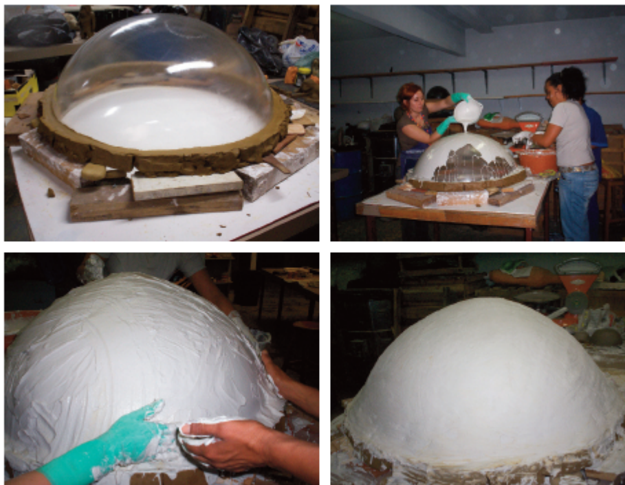
Figura 7, 8, 9 e 10 - Processo de criação de um molde de gesso. Atelier de Cerâmica do Instituto de Artes da Unesp, 2008. Foto: Flávia Leme.
