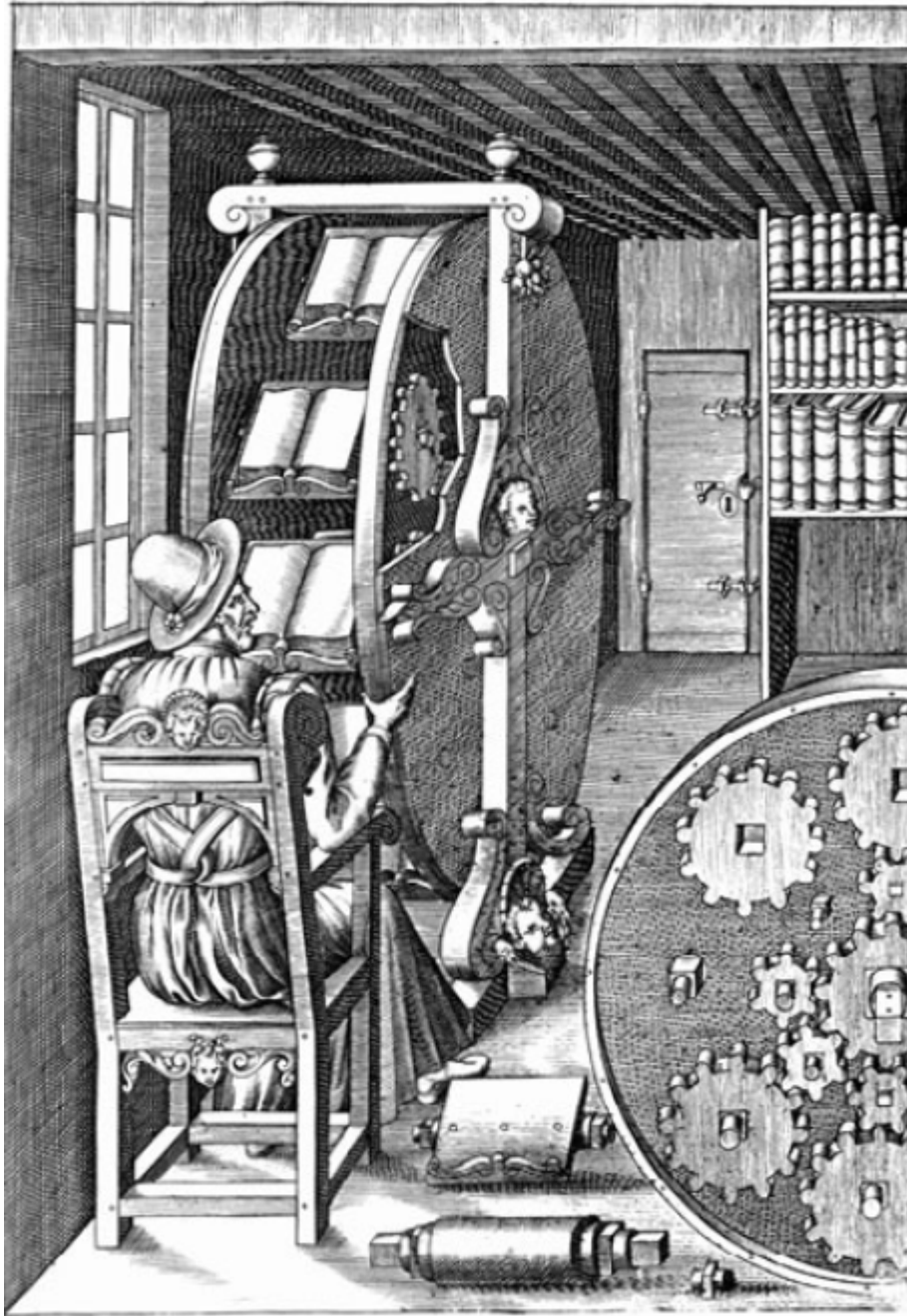
Figura 26: Roda de leitura de Ramelli, datada de 1588.
