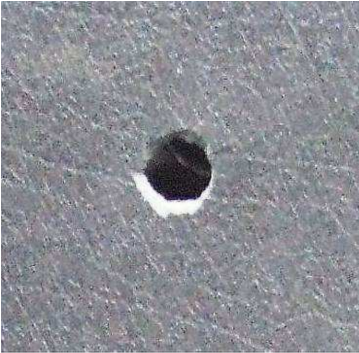
Ilustração 194 Orifício transfixante de saída de projétil de arma de fogo da forração plástica rígida das portas de um veículo automotor, com cone de fragmentação evidente na face de saída.
