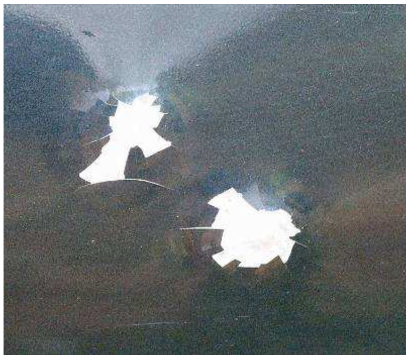
Ilustração 190 Amolgaduras produzidas por projéteis de arma de fogo incidindo de dentro para fora do veículo.
