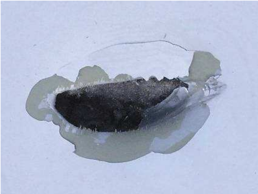
Ilustração 195 Orifício transfixante de entrada de projétil de arma de fogo em lataria de veículo automotor em trajetória oblíqua da direita para a esquerda.
