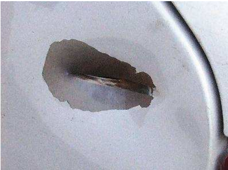
Ilustração 191 Amolgadura produzida por projétil de arma de fogo incidindo de fora para dentro do veículo e da direita para a esquerda.
