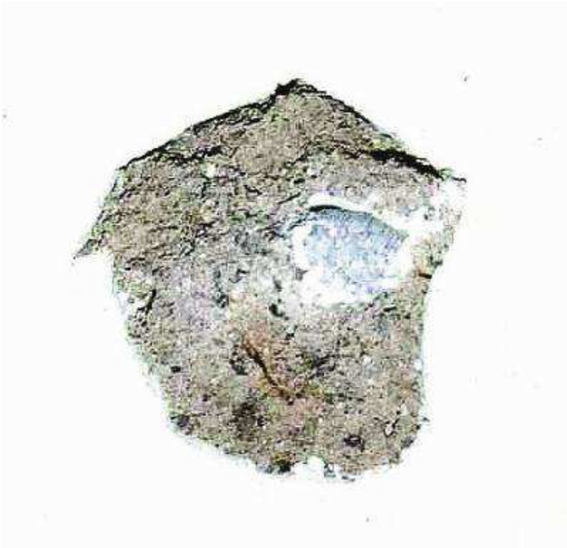
Ilustração 199 Escalavradura de projétil de arma de fogo (direita para esquerda), apresentando fundo com brilho metálico e desprendimento periférico.
