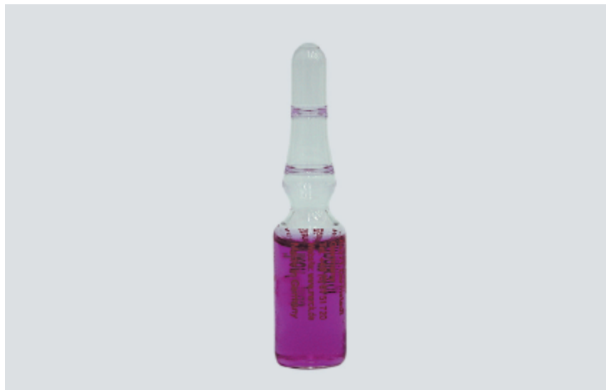
Figura 3.30 Indicador biológico Sterikon® com cultura de Bacillus stearothermophilus para monitorar eficácia da autoclavação.
