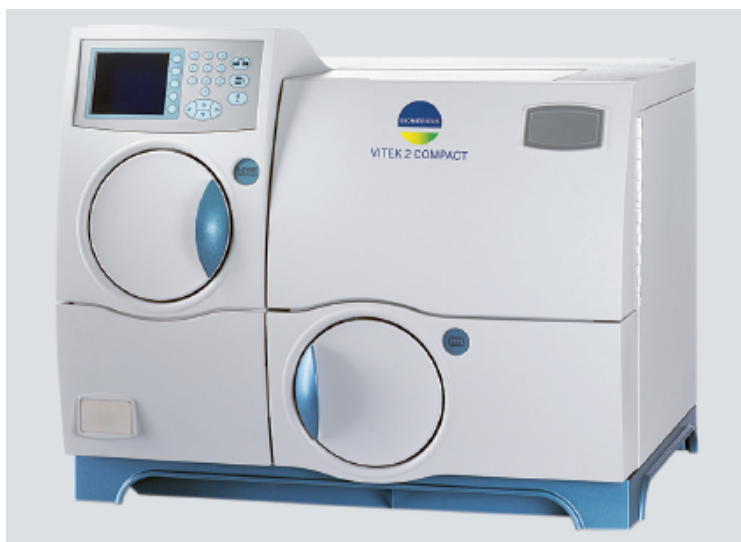
Figura 6.42 Vitek®2, em versão compacta. Equipamento para leitura das fitas multitestes API® (bioMérieux). (Foto: Banco de imagens oficial bioMérieux.)
