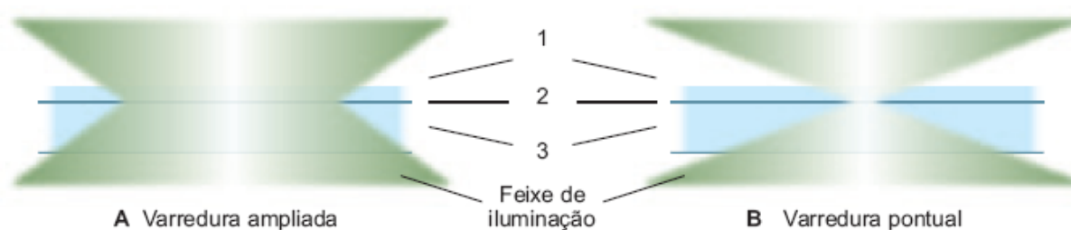
Figura 4.41 Comparação de dois tipos de feixes de iluminação de amostras marcadas com fluorocromos. Em A o feixe é alargado, iluminando várias regiões da amostra ao mesmo tempo. Em B um feixe extremamente fino ilumina uma área muito mais limitada. A vantagem do segundo feixe sobre o primeiro é que regiões ao lado do ponto de iluminação não são mantidas sob excitação, fazendo com que a meia-vida do corante fluorescente se prolongue. 1: lamínula; 2: espécime; 3: lâmina de vidro.
