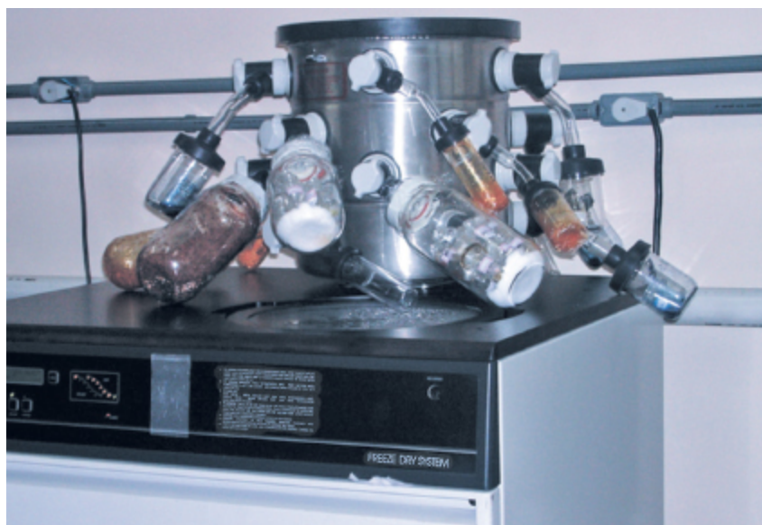
Figura 2.7 Liofilizador – aparelho utilizado para preservar microrganismos. A água presente no microrganismo congelado (mantido dentro das ampolas de vidro) passa ao estado gasoso sob alto vácuo, e nessas condições não há ruptura das estruturas celulares, que permanecem na forma de um pó seco.
