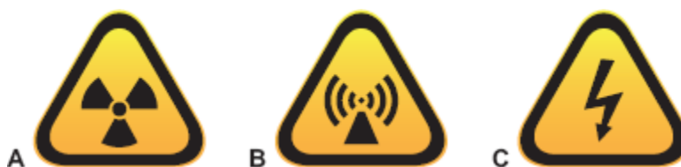
Figura 8.2 Símbolos relacionados a risco físico. A. Substância radioativa ionizante. B. Substância radioativa não ionizante. C. Eletrocussão.
