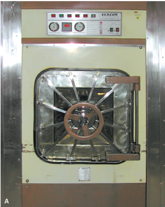
Figura 3.8 Autoclave hospitalar gravitacional com a porta fechada ( A ) e com a porta aberta ( B ), do Hospital Universitário Clementino Fraga Filho.
