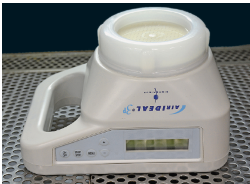
Figura 3.16 Sistema de amostragem de ar para a detecção de microrganismos no ar. Modelo Air Ideal®, bioMérieux. (Foto: Prof. Marco Antônio Miguel e Sergio E. Fracalanza)
