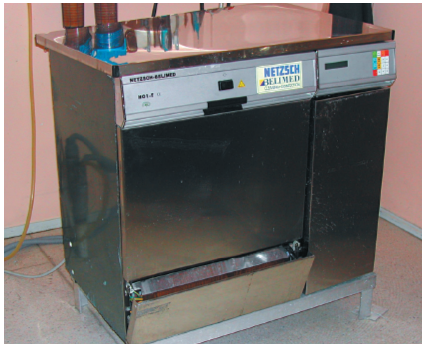
Figura 3.2 Máquina termodesinfetadora de água quente (70°C) do Hospital Universitário Clementino Fraga Filho, usada para materiais de assistência, ventiladores, traqueias, bolsas ventilatórias, máscaras ventilatórias e respiratórias, ambus (reanimadores manuais), conexões, conjunto para macronebulização e outros materiais. Essa máquina utiliza preparações industriais de detergentes enzimáticos com várias enzimas com atividade de lipase e peptidase.
