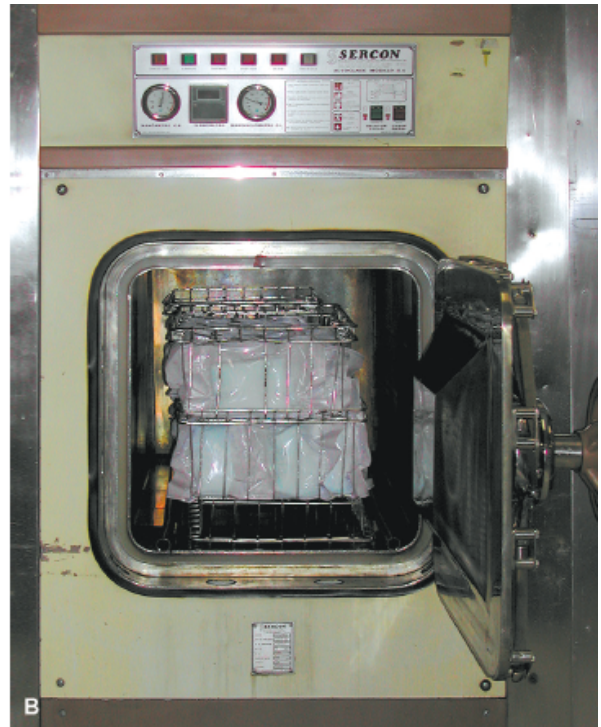
Figura 3.8 Autoclave hospitalar gravitacional com a porta fechada ( A ) e com a porta aberta ( B ), do Hospital Universitário Clementino Fraga Filho.
