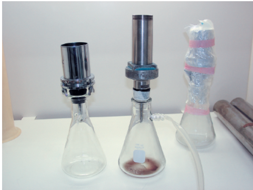
Figura 3.15 Meio de cultura esterilizado por filtração. O ar é removido por uma bomba a vácuo ligada a um kitasato.
