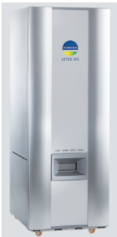
Figura 6.43 Vitek MS™, espectrômetro de massa utilizado para a técnica de MALDI-TOF. (Foto: Banco de imagens oficial bioMérieux.)
