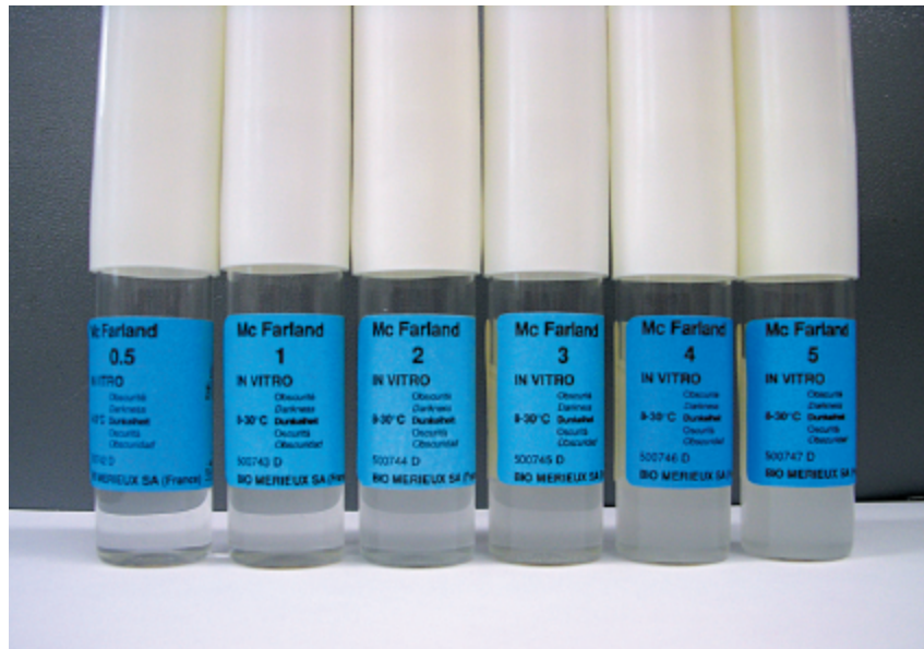
Figura 5.10 Escala de McFarland. Quantidades crescentes de sulfato de bário fornecem turvações crescentes.
