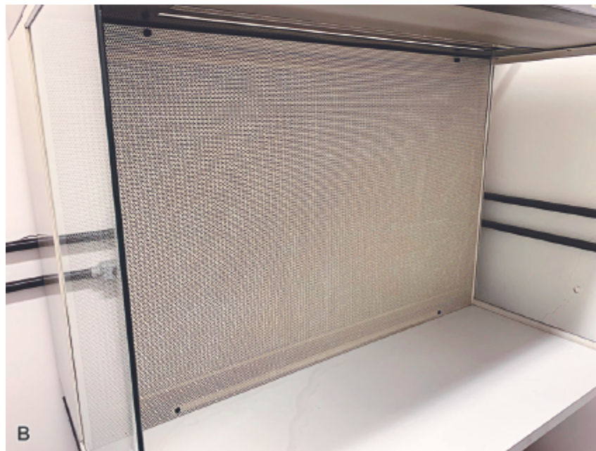
Figura 9.1 Fluxos laminares. Os fluxos laminares podem ter a disposição do filtro HEPA na posição vertical ( A ), onde fica localizado na porção superior do equipamento, ou na posição horizontal ( B ) onde a posição do filtro fica de frente para o operador, como pode ser observado na foto. Notar a lâmpada ultravioleta (UV) acesa no fluxo laminar vertical ( A ).
