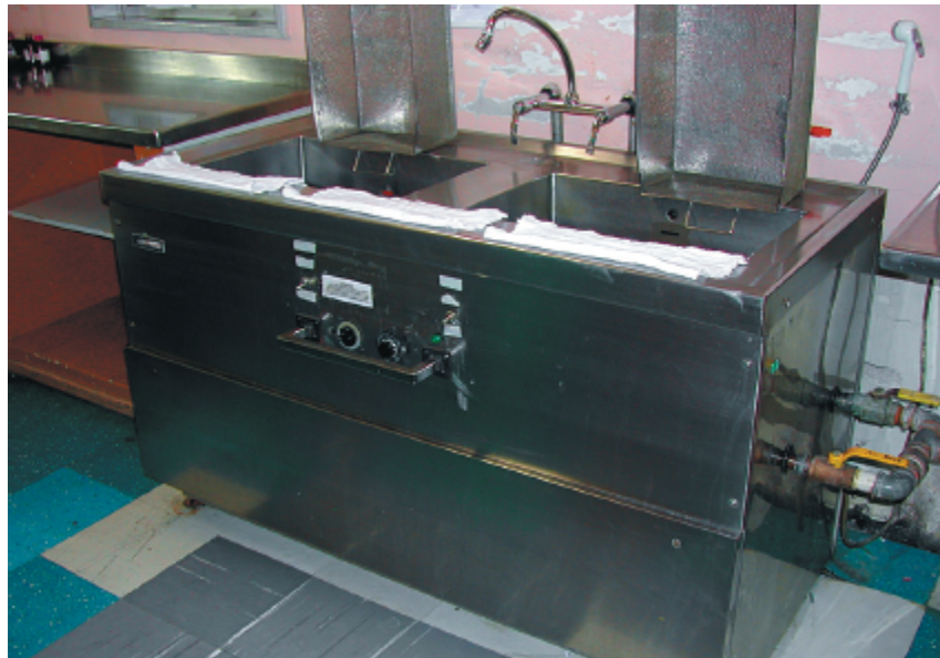
Figura 3.1 Bacia ultrassônica do Hospital Universitário Clementino Fraga Filho. Com vibração ultrassônica e água a 40°C, ela auxilia a limpeza de material cirúrgico, bandejas, caixas, pinças, material de cirurgias ortopédica e neurológica e materiais canulados com lume.
