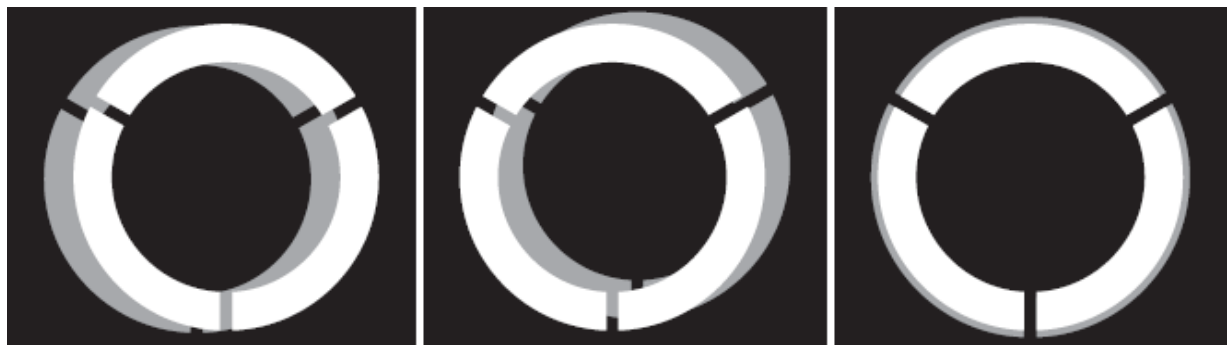
Figura 4.33 Alinhamento dos anéis de fase no microscópio de contraste de fase. Por meio de dois pequenos parafusos no condensador ajusta-se o anel brilhante em relação ao anel escuro que fica inserido na objetiva. A imagem mostrará o melhor contraste quando os anéis estiverem coincidentes.
