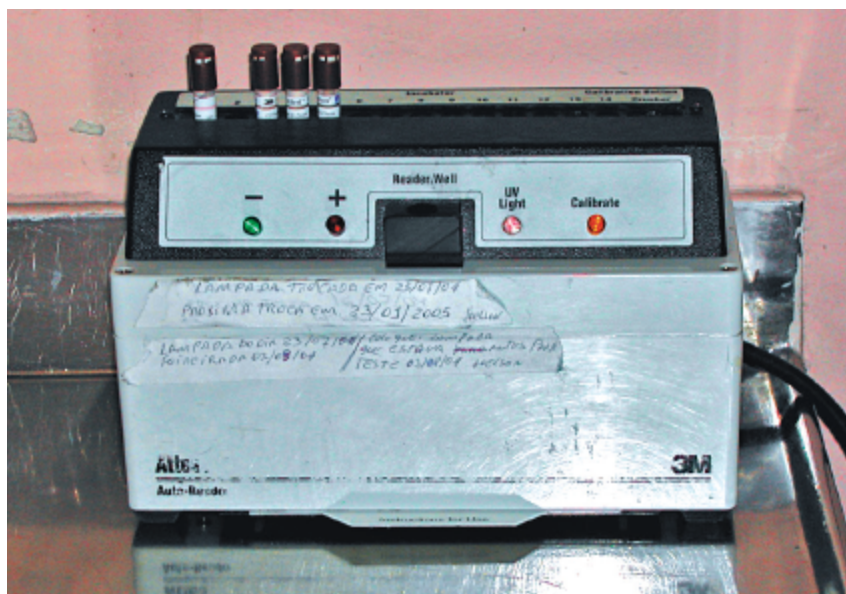
Figura 3.31 Aparelho para incubar as amostras-padrão recolhidas após o processo de autoclavação e colocadas em meio de cultura, Hospital Universitário Clementino Fraga Filho.
