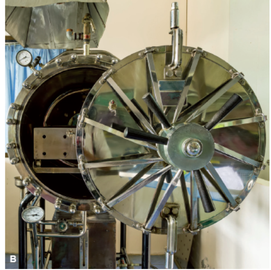
Figura 3.7 A. Autoclave usada em clínica odontológica. B. Autoclave hospitalar. O material é seco posteriormente.
