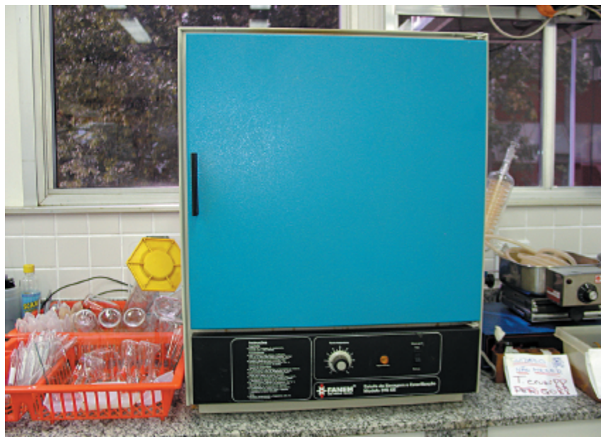
Figura 3.12 Estufa de secagem de material e esterilização. (Foto: Instituto de Microbiologia Paulo de Góes.)
