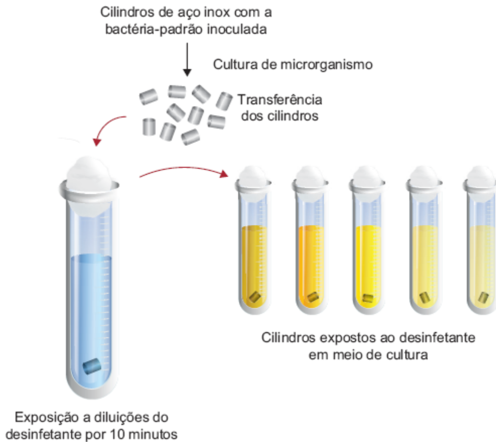
Figura 3.20 Método da diluição de uso. Neste método, cilindros de aço inox são contaminados com a bactéria-teste e colocados na presença de diluições do desinfetante. Após 10 minutos, os cilindros são adicionados em meio de cultura para avaliar sua viabilidade.
