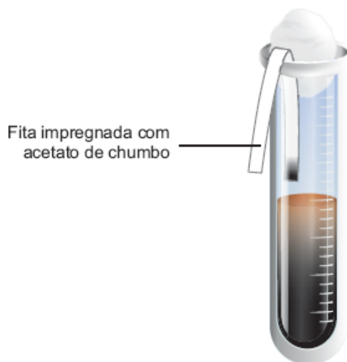
Figura 6.27 Teste da fita impregnada com acetato de chumbo para detecção de \text{H}_2\text{S} .
