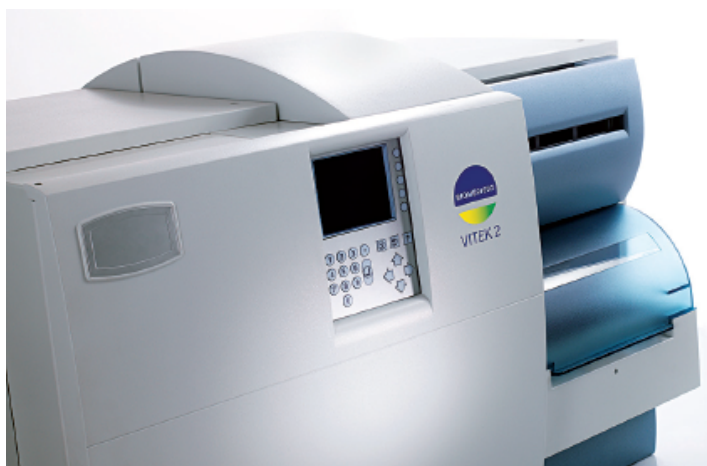
Figura 7.2 Aparelho Vitek®2 (bioMérieux) de automação para leitura das cartelas inoculadas para realização do teste de susceptibilidade a antimicrobianos. Após a inoculação das cartelas, elas são incubadas na unidade de incubação e leitora do aparelho, onde são feitas leituras sucessivas da densidade óptica de cada poço da cartela, que são processadas por programas específicos no computador, para posterior impressão dos resultados: sensível (S), resistência (R) ou resistência intermediária (I). (Foto: Banco de imagens oficial bioMérieux).
