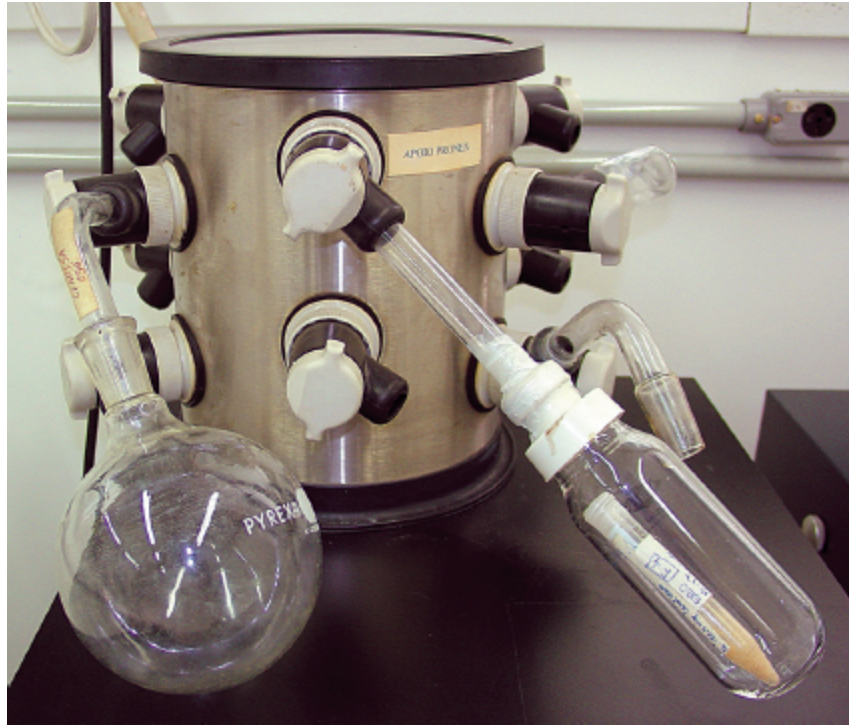
Figura 3.18 Liofilizador. Aparelho que emprega congelamento rápido e posterior sublimação da água. (Foto: Instituto de Microbiologia Paulo de Góes.)
