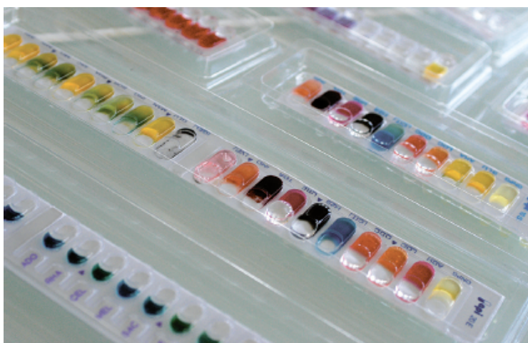
Figura 6.38 API® (bioMérieux). O sistema de multitestes, no formato de pequenos poços chamados de microtubos, possui vários compartimentos contendo meios para identificação bioquímica. (Foto: Banco de imagens oficial bioMérieux.)
