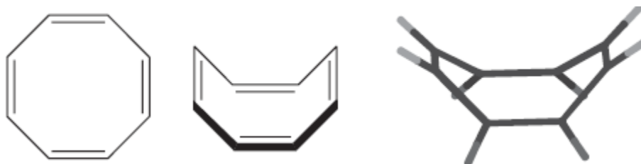
Figura 9.10 Estrutura do ciclo-octatetraeno (esquerda) e sua conformação tridimensional (centro e direita).
