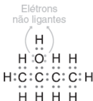
Figura 1.42 Representação da molécula de butan-2-ol no modelo estrutural de Lewis.
