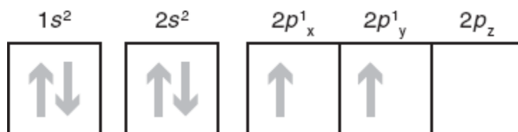
Figura 1.23 Configuração eletrônica do carbono no estado fundamental.
