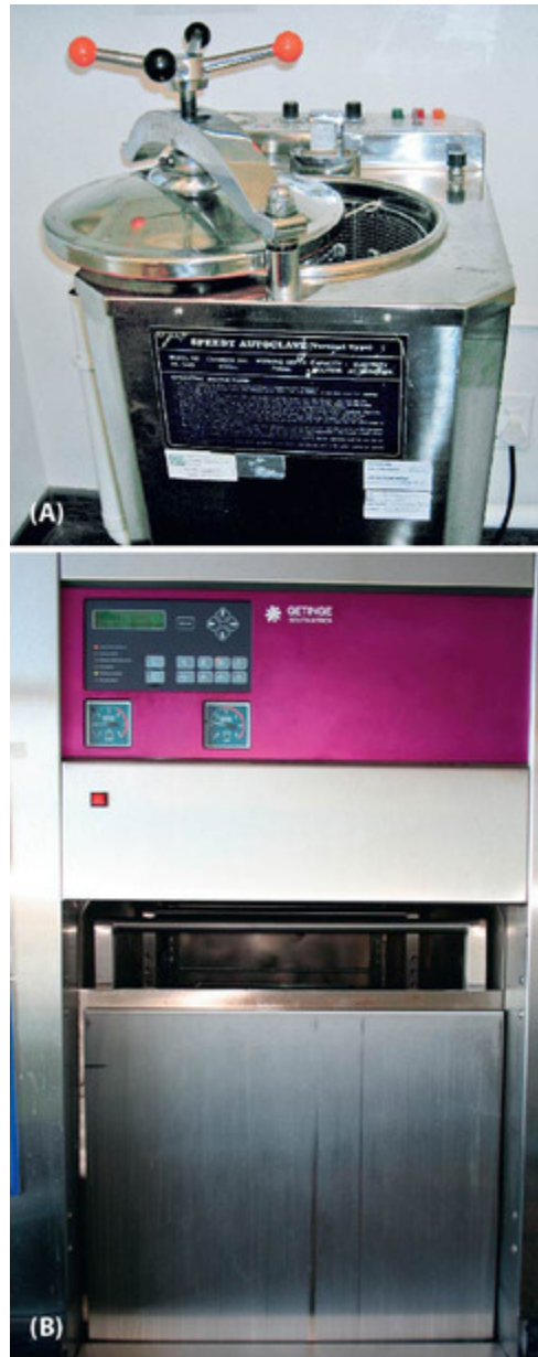
FIG. 3 Autoclaves de carregamento (A) superior e (B) frontal. São utilizados tamanhos diferentes, dependendo das necessidades das instalações.
